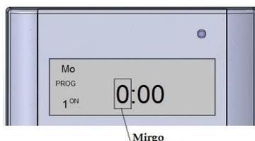
5. Mit der Taste < oder > Stunde für Einschaltung des Geräts im Arbeitsbetrieb einstellen in der Zeitspanne von 0 bis 24 Stunden.
